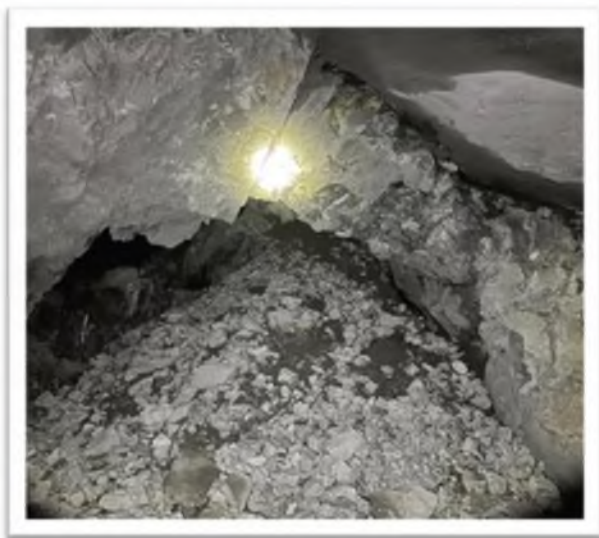
Slika 6.8. Zapunjavanje starih otkopa jamskim nemineralizovanim otpadom: otkop na V horizontu (levo) i komora na VIII horizontu (desno)
