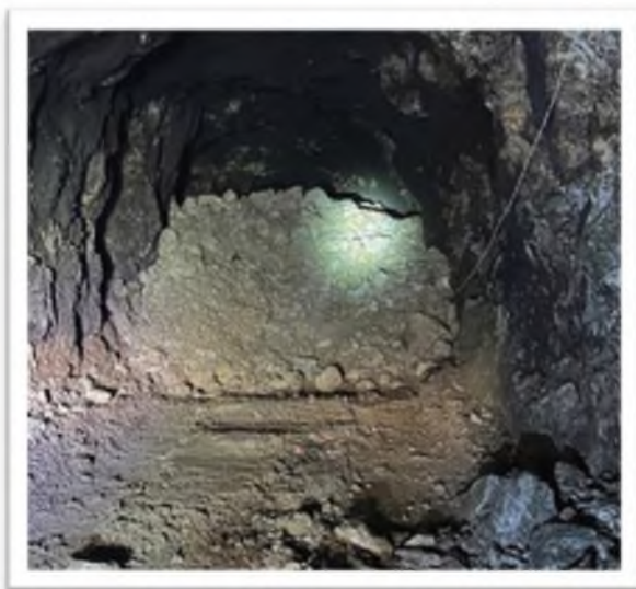
Slika 6.8. Zapunjavanje starih otkopa jamskim nemineralizovanim otpadom: otkop na V horizontu (levo) i komora na VIII horizontu (desno)
