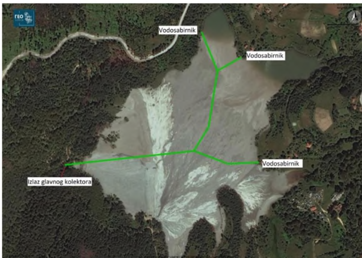
Slika 6.3. Šema položaja kolektora i vodosabirnika na jalovištu (Izvor: Google Earth)
