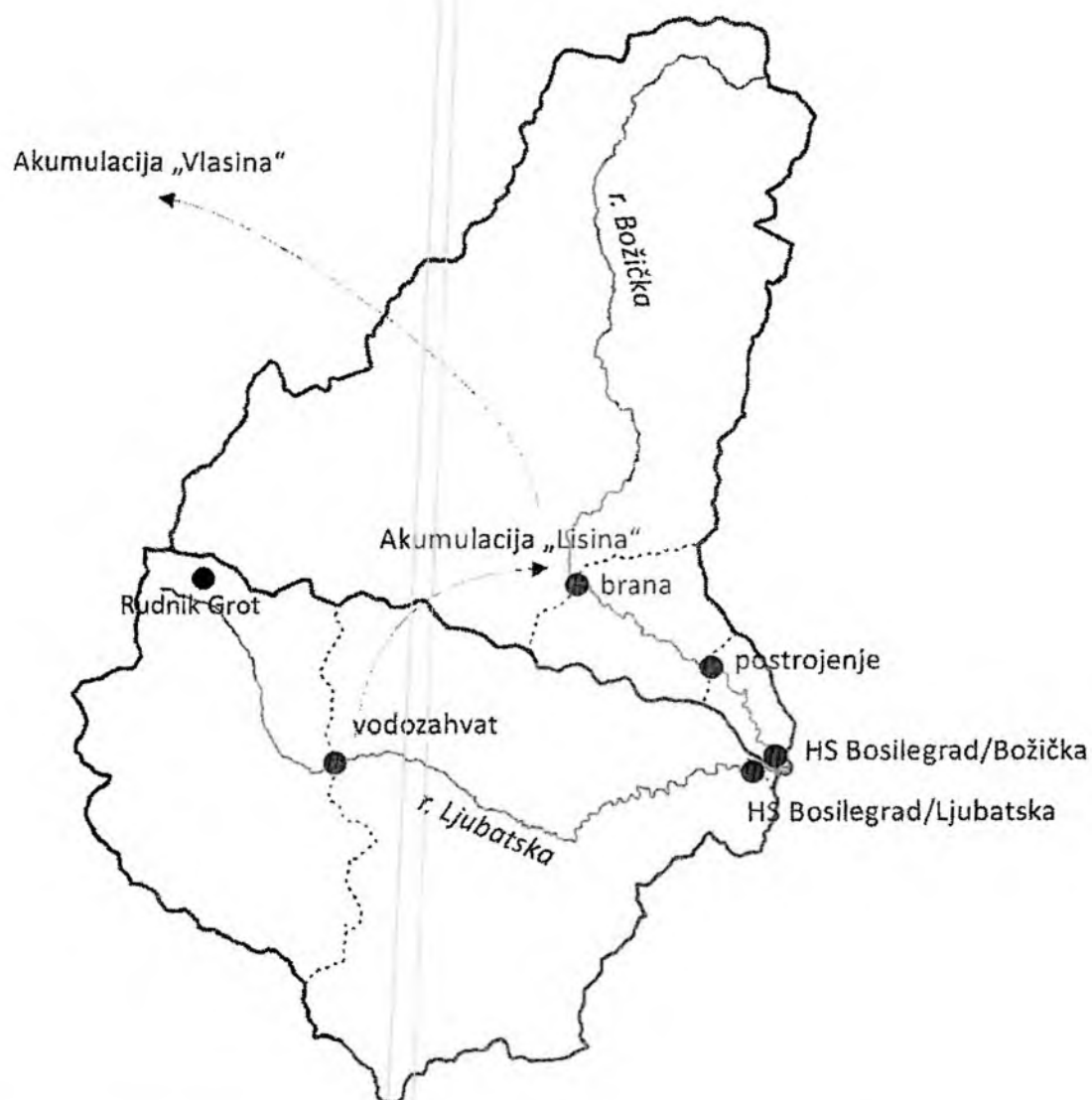
Слика 1. Шематски приказ сливова Божичке и Љубатске реке и пребацивање вода
